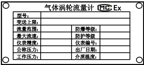
图 2.1 (d) 温压补偿型涡轮流量计铭牌
