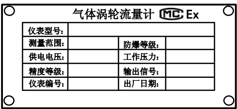
图 2.1 (c) 低功耗型涡轮流量计铭牌
