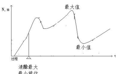
**峰（谷）值**：测量转矩过程中，转矩由小变大，再由大变小，变化量绝对值大于峰谷判断门限时，仪表自动刷新新峰值，转矩由大变小，再由小变大，变化量绝对值大于峰谷判断门限时，仪表自动刷新新谷值。
