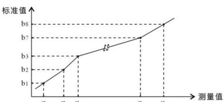
★ 小于 **C1** 的测量值，仪表按后一段的数据向下递推；大于 **C8** 的测量值，仪表按前一段的数据向上递推
