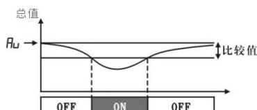
**HLP-S** 表示 总值与给定值  $R_U$  的偏差绝对值 > 比较值时,输出导通
